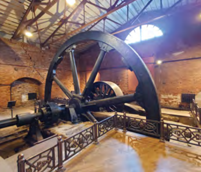
^ Рис. 12. Помещение колеса привода прокатного стана. 2025
