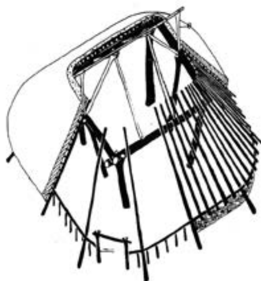
^ Рис. 2. Конструктивно-пространственная схема татеана. Изображение из трактата Тиссан-Хиссё (XVIII–XIX вв.)
