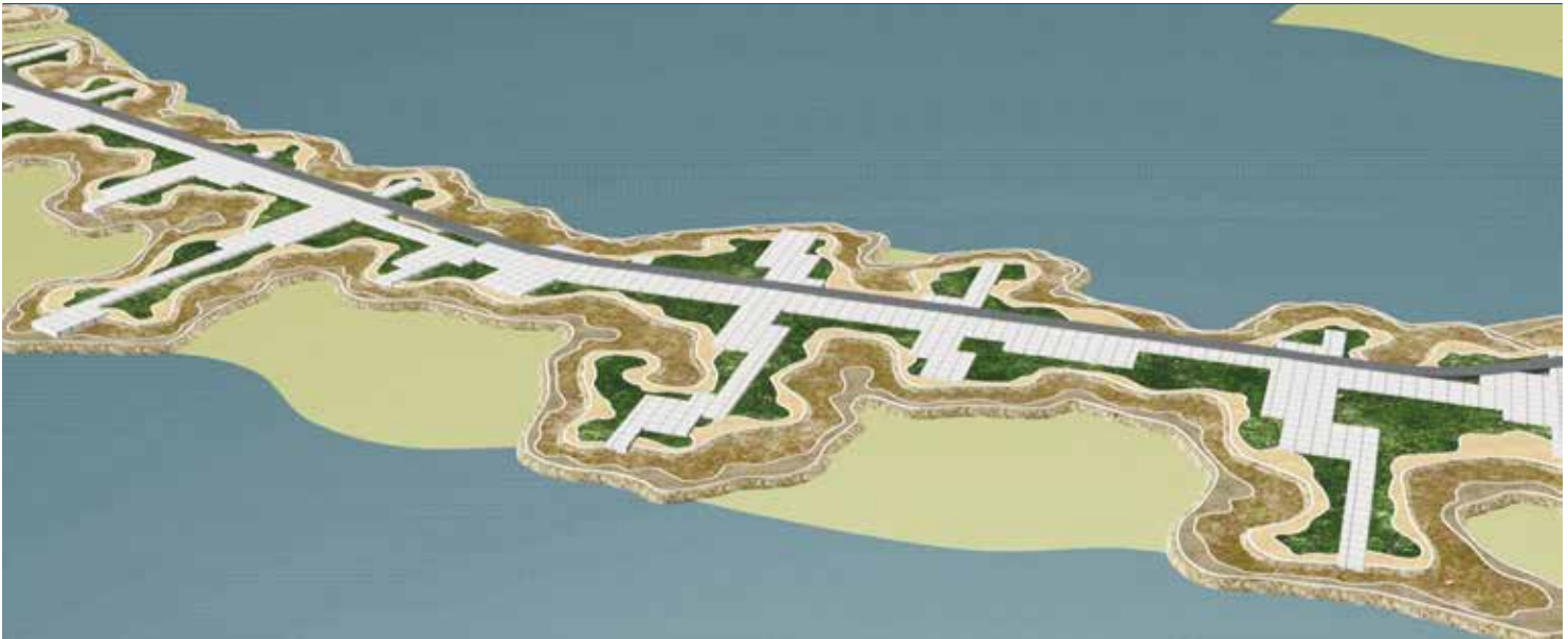
Рис. 4. Прием геопластического моделирования обваловки трубы
