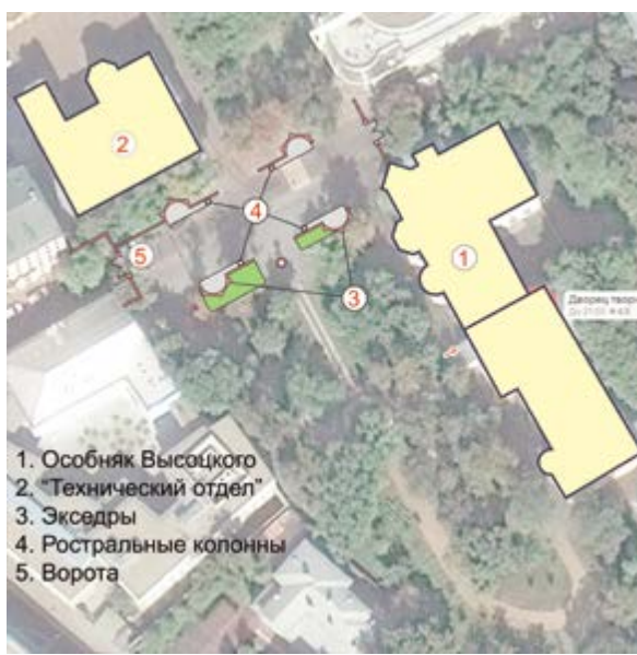
> Рис. 14. Дворец пионеров и октябрят в пер. Стопани, 5. Схема расположения объектов и реконструкции утраченных элементов благоустройства перед дворцом (1946)
