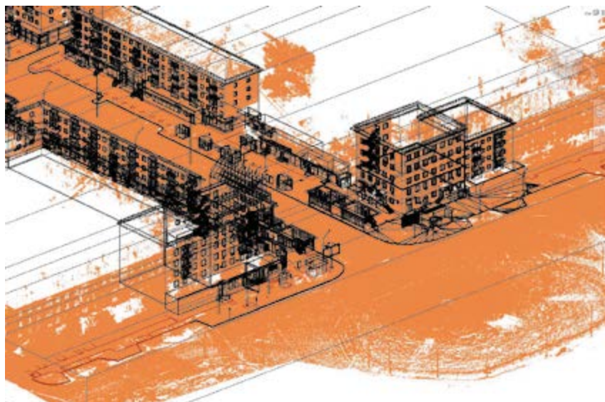
> Рис. 1. Создание цифровой информационной модели проспекта Карла Маркса по материалам лазерного сканирования
