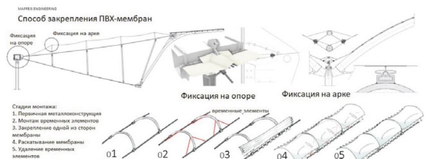
v Рис. 7. Способ закрепления ПВХ-мембран на стадионе в Волгограде
