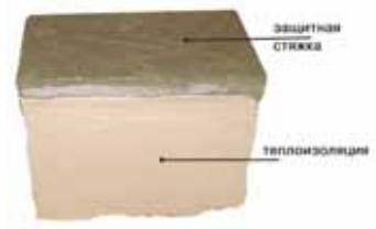
Теплоизоляция чердачного перекрытия «Поропластом CF 02» Фрагмент теплоизоляции
