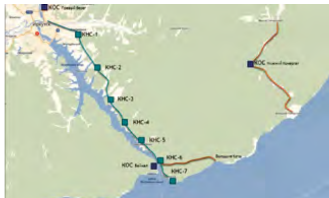
^ Рис. 3. Схема водоотведения и очистки сточных вод от Листвянки до Иркутска
