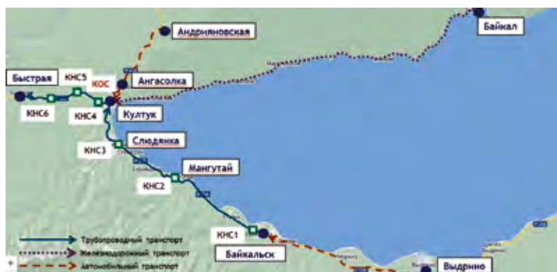
^ Рис. 4. Варианты организации системы водоотведения в южной части побережья озера Байкал
