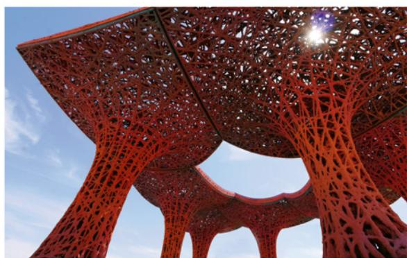
Цифровое производство и сборка включали роботизированное распыление и фрезерованные на ЧПУ формы, что значительно сократило время изготовления и позволило достичь процента отходов материала на уровне всего 5%. Сложность сборки была сведена к минимуму благодаря высокой степени предварительной сборки ячеистых модулей.
