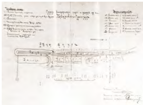
^ Рис. 36. Станция Хабаровск-Пристань. План расположения путей и зданий на станции с указанием участков для нужд Восточной Амурской железной дороги [5]
