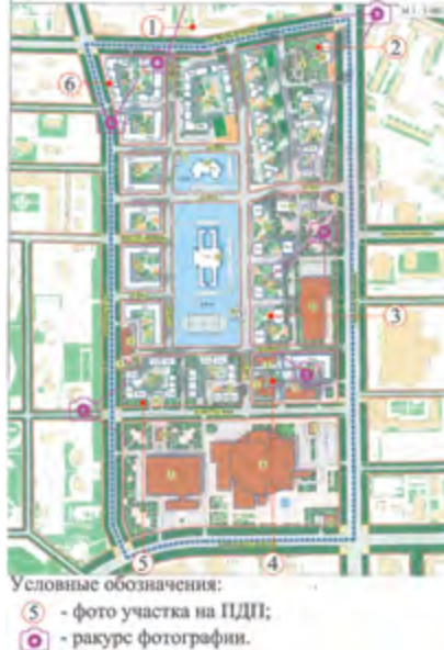
^ Рис. 2. Сравнительный анализ градостроительных решений и натурного обследования района Позиция 1. Сочетание архитектурных стилей; Позиция 2. Вместо рекреационной зоны построен жилой комплекс; Позиция 3. Вместо 14 этажей, отмеченных в ПДП, построено 16 этажей. Неосвоенная центральная часть района; Позиция 4. Придомовая территория жилого комплекса; Позиция 5. Увеличение количества проездов, вместо зеленой зоны; Позиция 6. Отсутствие «защитных» насаждений
