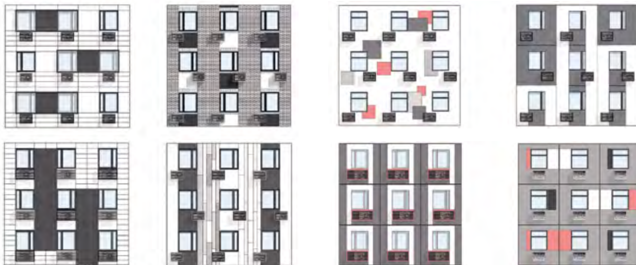
^ Рис. 6. Примерные схемы модернизации фасадов путем зрительного изменения ритма чередования и пропорций оконных проемов
