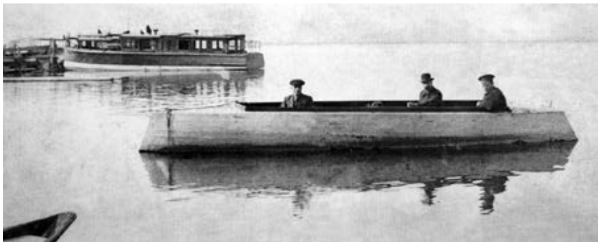
^ Братья Гольдберг сконструировали первый в Иркутске самоходный баркас, переставив на него двигатель от опять же пегово в городе автомобиля. Его они выкупили в связи с поломкой.
